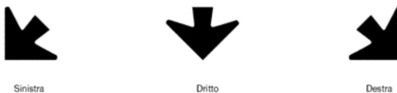
Sono poste sulla parte inferiore di ciascun segnale di corsia ed al centro di esso, salvo quando indicano una corsia di uscita, di svolta, o comunque diver-
